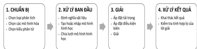
Hình 3: Sơ đồ mô khối mô tả thuật toán giải quyết bài toán tương tác nhiệt – cơ tuần tự trong phần mềm ANSYS APDL
