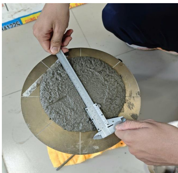
Hình 2: Thí nghiệm đo độ lưu động mẫu vữa
