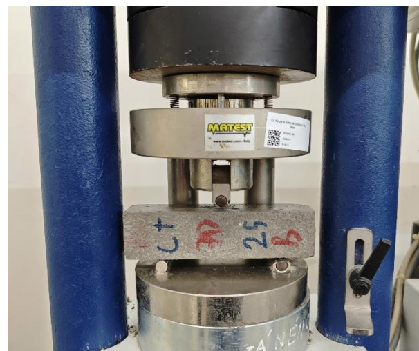
Hình 3: Thí nghiệm cường độ chịu uốn mẫu vữa
